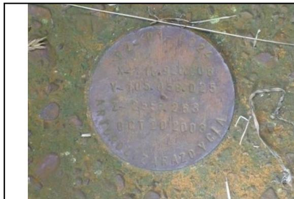
**Foto No. 1. Placa de identificación y georreferenciación.**
